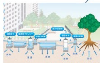
雨水地下浸透・透水性舗装
