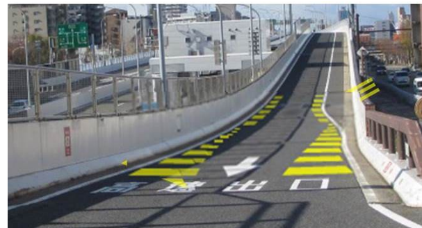
逆走車や歩行者等の立入対策（黄色カラー補正施工イメージと逆走検知・警告システム）
