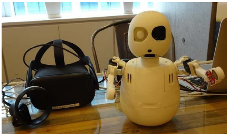
テレプレゼンスロボットの“ワープマシン”。 利用者がヘッドセットを被って頭や手を動かすと、 ロボットの頭や手もほぼ同時に動く
