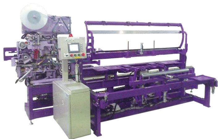
畳を製造する全自動平刺・返縫機 両用ロボット ヴィクトリー
